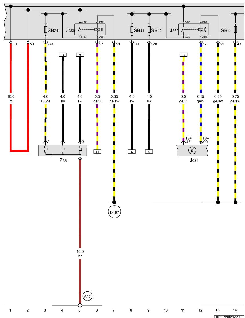
小加热功率继电器, 大加热功率继电器, 空气辅助加热装置加热元件
